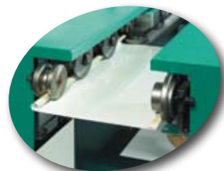
Profilowanie zawinięcia i zacisku
