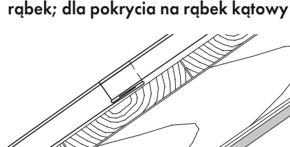
Połączenie poprzeczne: rąbek w rąbek; dla pokrycia na rąbek kątowy
