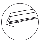
Zakończenie okapu stojące, ukośne
