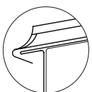
Zakończenie okapu stojące, okrągłe
